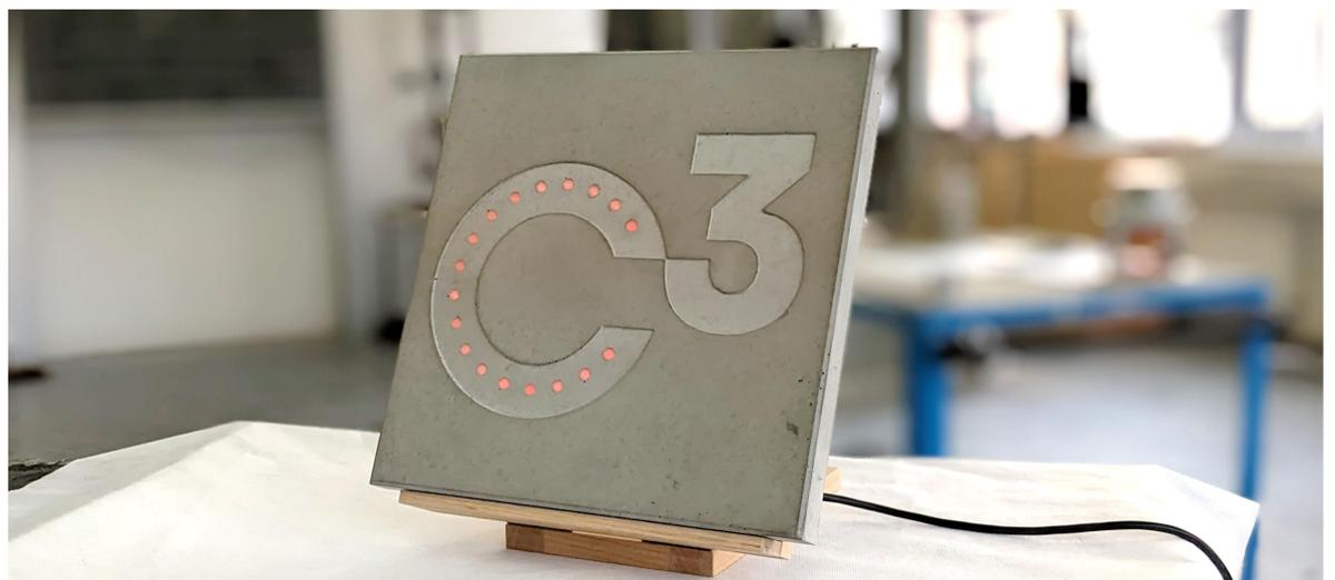
Abb. 1. CarboCapSense Demonstrator: Kapazitives Schaltelement auf Basis von Carbon-Rovings
